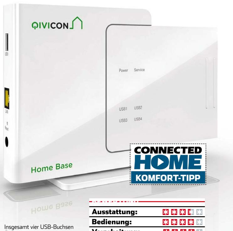
Insgesamt vier USB-Buchsen sind in der **QIVICON Home Base** eingebaut. Über optional erhältliche Funksticks erweitert sich so ihr Produktspektrum um Z-Wave oder ZigBee.
